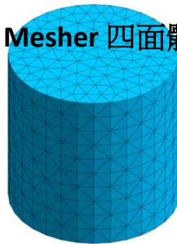
Hybrid Mesher(混合網格)=>六面體元素為主+五面體元素
