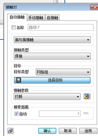
接觸管理器：查看、修改和管理接觸定義；自動接觸：可以通過部件之間的距離自動計算並建立接觸。
