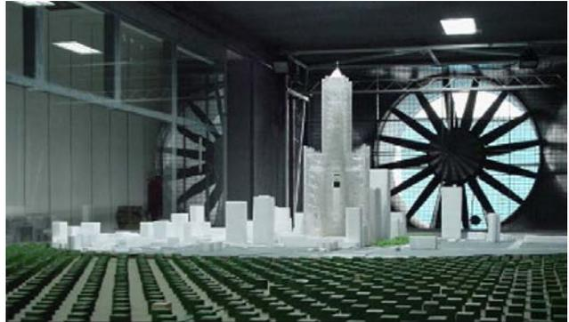
分析目的現有的建築規範已經無法滿足多種風載的景觀造型橋，過去必須採用風洞實驗，現在則是可以利用CFD分析計算，得到與風洞實驗相同結果，另外，CFD分析是采同等比例尺寸模型，結果更貼近實際情況。除了進行風場分析，NFX-CFD風壓直接代入NFX-CAE有限元模型進行橋體結構強度計算。
