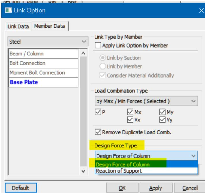
2. Base Plate支援的Section Shape 有 H Section, Box, Pipe, Angle, Channel 等，請確認Section Type 是否符合可匯入的類型。
