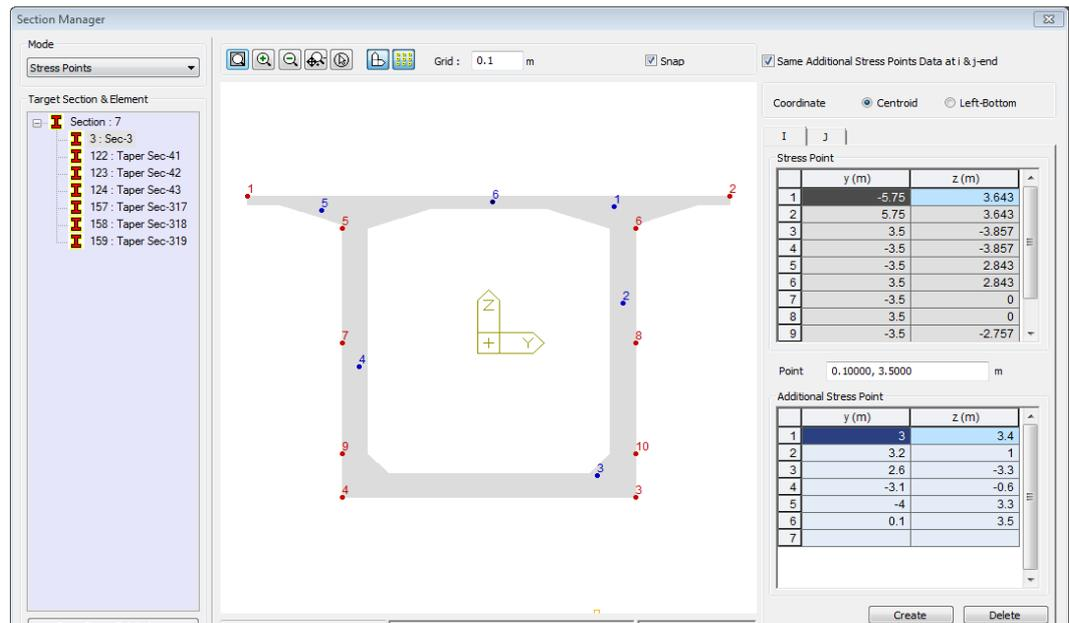
若斷面性質為DB、PSC/PSC Value、Tapered Section、Composite Section、General 或 Composite General Section，新應力點可以設定在任何新位置。如果是Composite Section，應力點只能設定在Part2。
