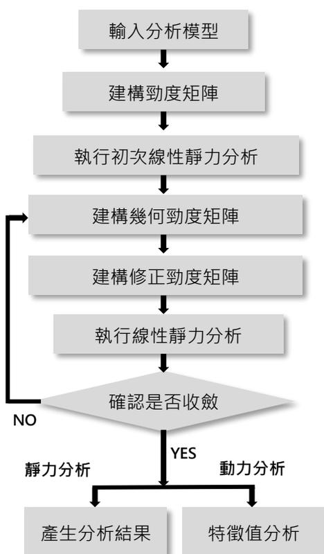
線性靜力分析執行須先有一給定載重條件，再有一新建構的幾何進度矩陣，此矩陣是基於第一次分析所獲得的桿件力量或桿件應力獲得的。幾何勁度矩陣會不停的被修正，並用以執行下次的靜力分析，直到收斂的條件符合。
