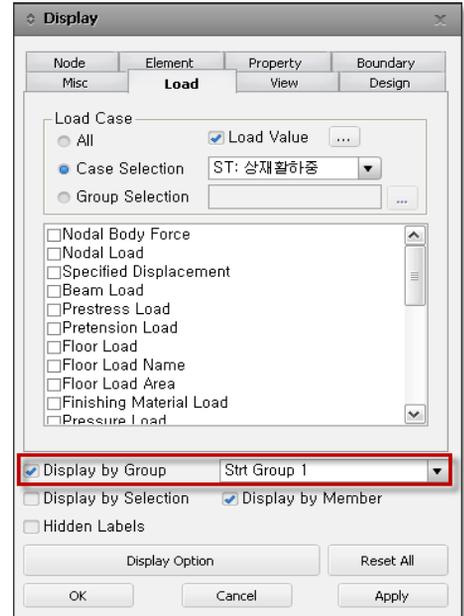
“Display by Group” 項目功能通常運用於加荷載，以及所有可在midas Civil中顯示的各項功能信息中。
